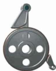
图 4-6 摩擦式棘轮机构
