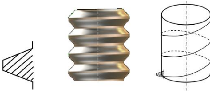
图 7-2 螺纹的形成
